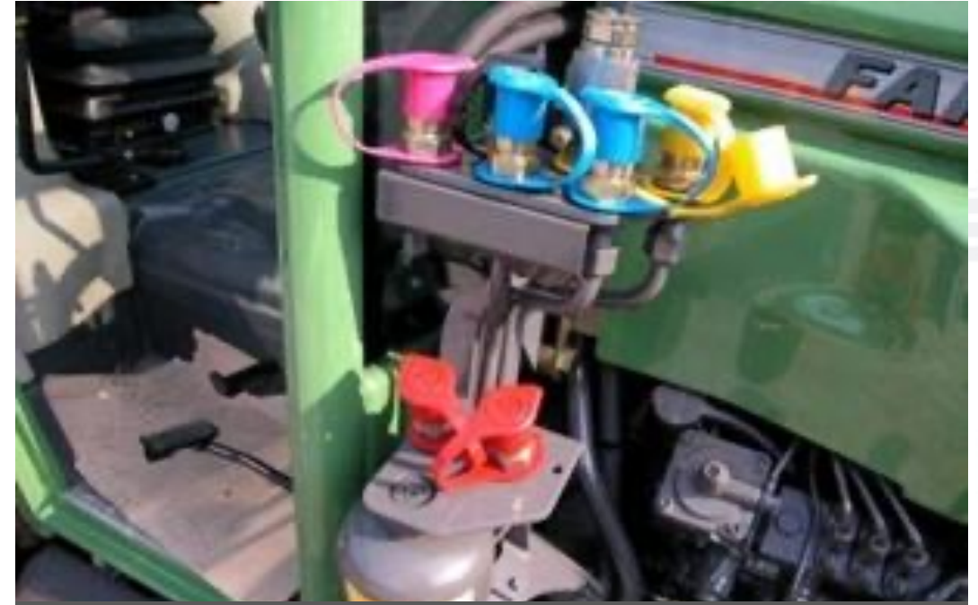
Collegamenti idraulici identificabili
