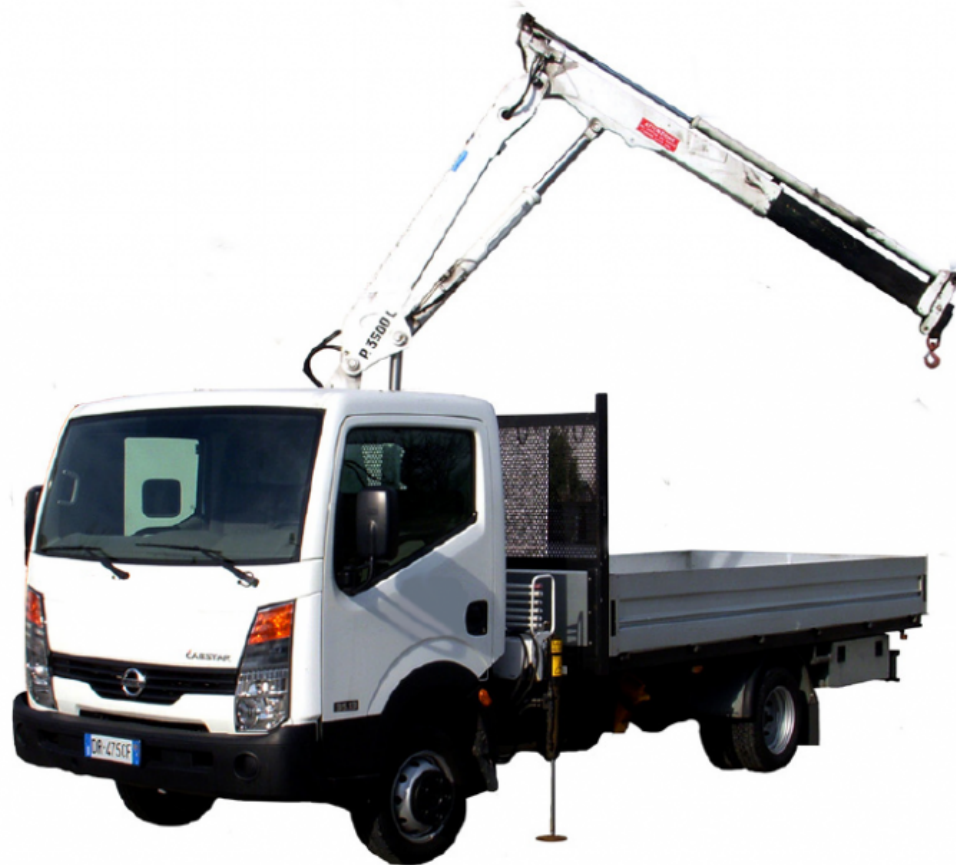
GRU RETRO - CABINA
